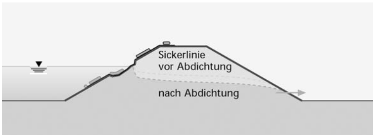
Abb. 56: Abdichten/Sichern von lokalen Wassereintrittsstellen (Schnitt)
