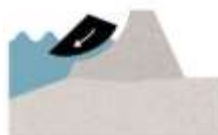
Falen van de bekleding
